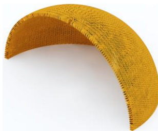
شکل ۱۴: اجرای شیوه آجرچینی گردچین در عرقچین (مسجد نبی سهند تبریز)
