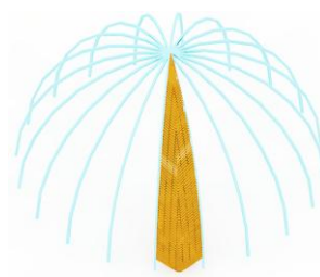
شکل ۱۳: اجرای شیوه آجرچینی ترک به ترک در عرقچین (پل بازار تبریز) (منبع: فرهاد تهرانی)
