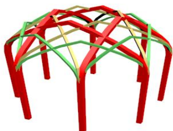
شکل ۱۵: اجرای عرقچین با لنگه‌های شبیه به کاربردی (حمام نویر تبریز)
